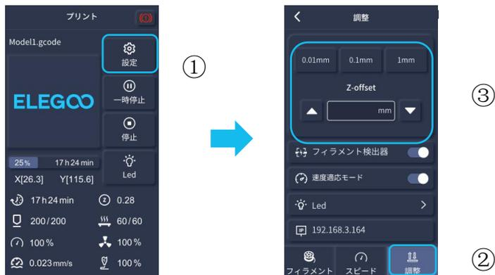
③ 注意: 微調整を行う際、ノズルがプラットフォームを過度に押し下たり、フィラメントが空中で吊るされたりするのを防ぐため、移動距離を0.01mmまたは0.1mmに切り替えてください。
